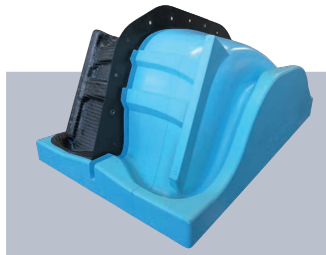
Prepreg nástroj z Ebaboardu EP 138 na závodní sedadlo
