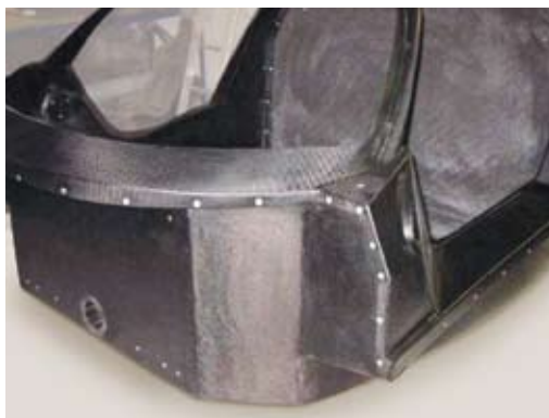
CFK prepregová struktura (část karoserie), vyrobená ebacrylovými nástroji
