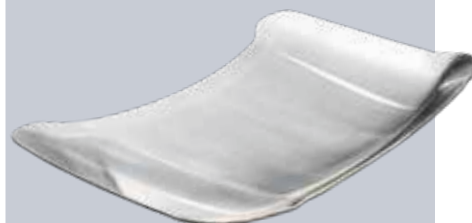
Pokovený nástroj vyrobený v galvanické lázni na Ebablocku P 185
